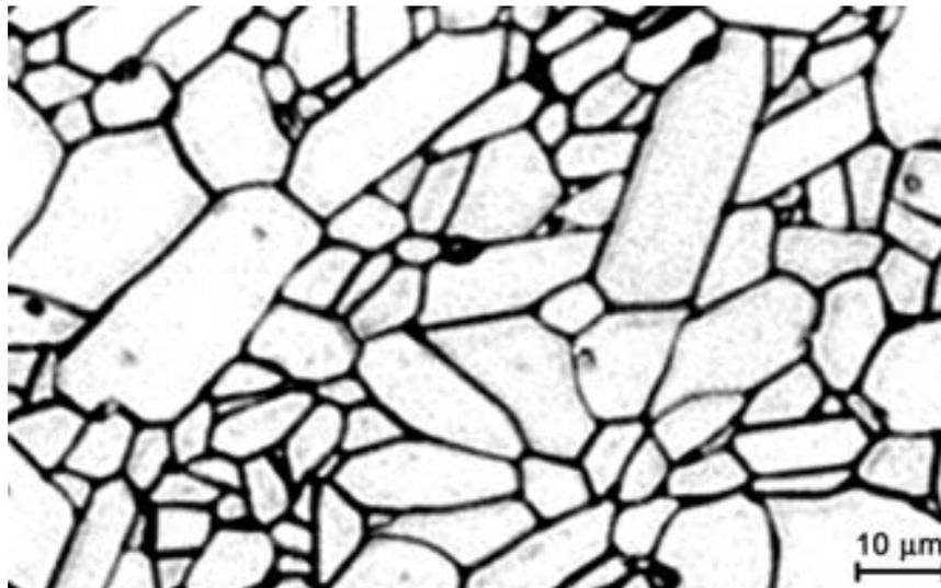
**Bild 7:** Gefüge von Aluminiumoxidkeramik (99,7 %)
