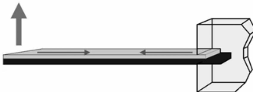
**Bild 27:** Das Anlegen der Betriebsspannung verursacht eine Kontraktion der Piezokeramik und damit die Biegung
