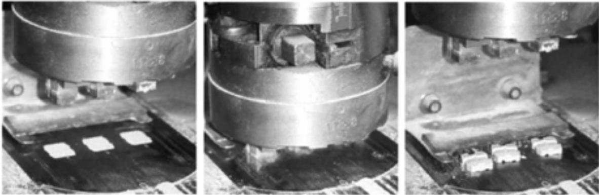
**Bild 53:** Trockenpressvorgang
