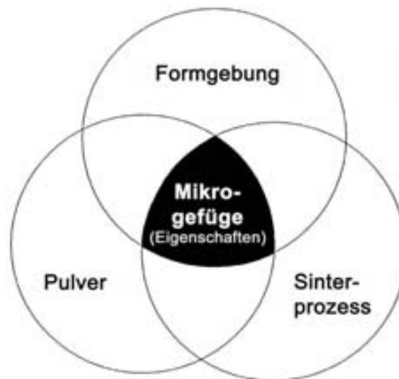
**Bild 48:** Einflüsse auf das Mikrogefüge
