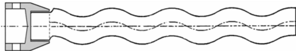
**Bild 205:** Exzentrerschnecke aus Siliciumcarbid
